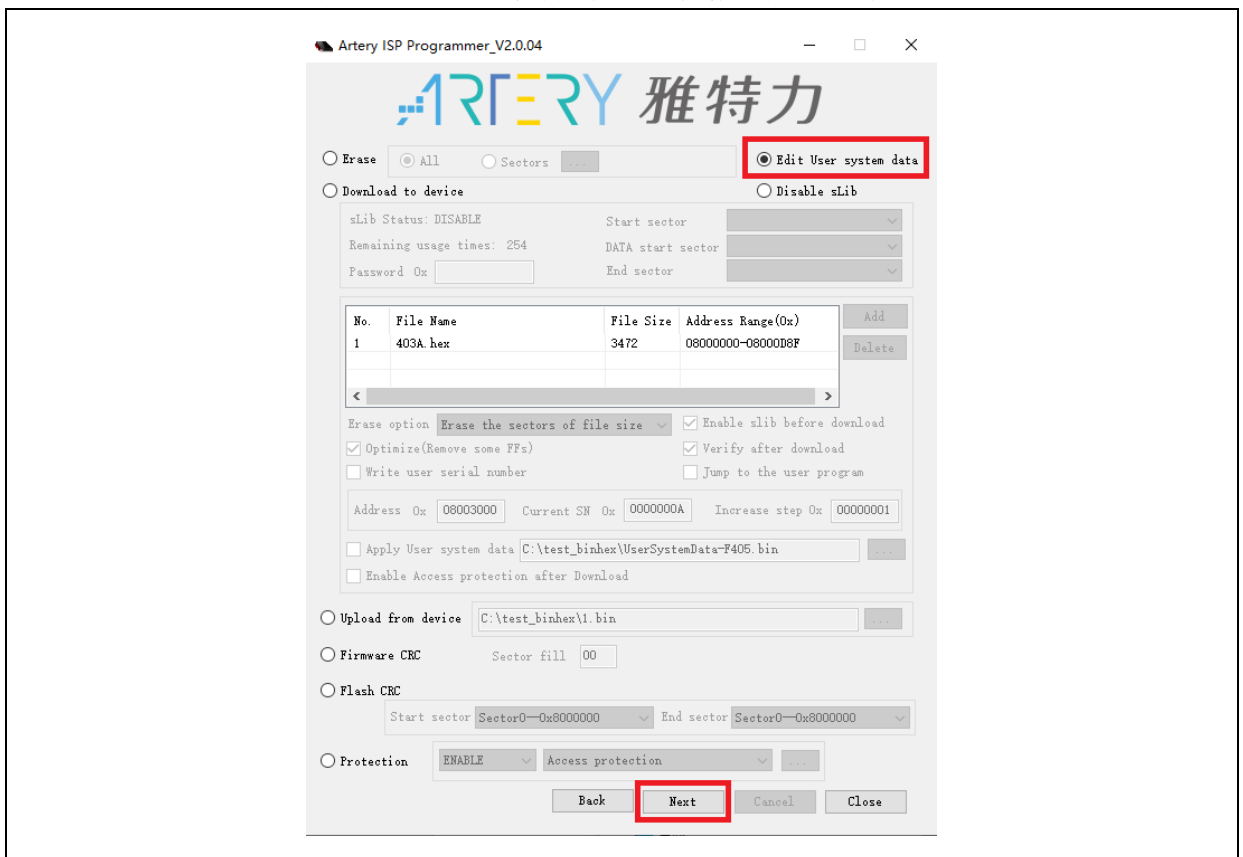
图 43. ISP 工具编辑用户系统数据选择 SRAM 大小
