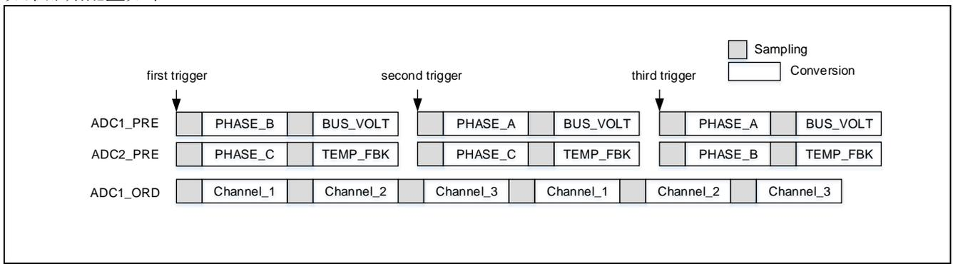
ADC1 有普通组在转换，不停切换 ADC1 抢占组通道导致普通组转换结果错序，遇到这种情况，可以将 ADC1 的通道固定，改为切换 ADC2 的抢占组通道，调整后配置如下：
